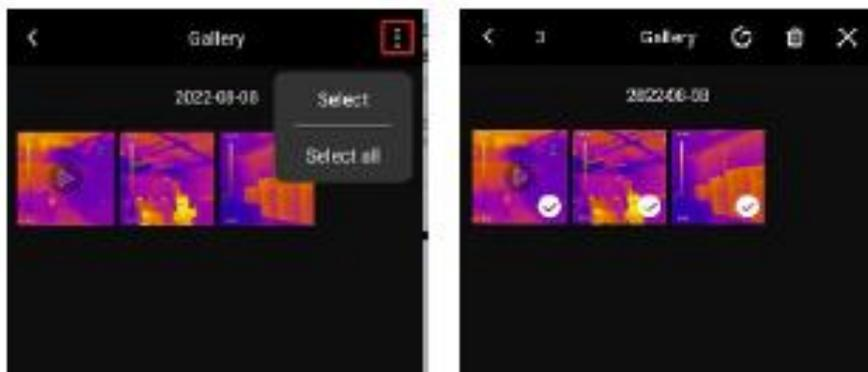
Tippen Sie auf ein Bild/Video, um eine Oberfläche aufzurufen, in der Benutzer dieses Bild/Video in der Vorschau anzeigen/teilen/löschen/bearbeiten (nur Bild) können, sowie seinen Modus für PIP/Fusion oder detaillierte Informationen anzeigen können (Dateiname, Datum, Uhrzeit, Auflösung, Punkt mit maximaler Temperatur, Punkt mit minimaler Temperatur, Mittelpunkt, Modus, Emissionsgrad).
