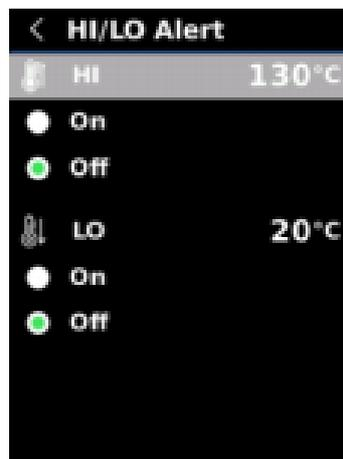
Nell'interfaccia delle impostazioni, premere il pulsante Su/Giù per selezionare "Allarme HI/LO" e premere il pulsante SET per accedere all'interfaccia di impostazione dell'allarme. Premere il pulsante Su/Giù per selezionare On/Off. Premere il pulsante SET per impostare il valore di allarme. Premere il pulsante Su/Giù per aggiungere/sottrarre. Premere il pulsante Indietro per tornare all'interfaccia precedente.
