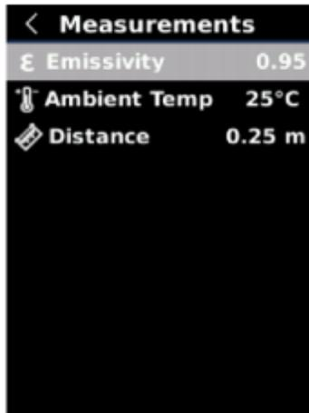
Nell'interfaccia delle impostazioni, premere il pulsante Su/Giù per selezionare "Misure" e premere il pulsante SET per accedere all'interfaccia di impostazione. Premere il pulsante Su/Giù per selezionare Emissività/Temperatura ambiente/Distanza e premere il pulsante SET per impostare il parametro selezionato. Premere il pulsante Su/Giù per aggiungere/sottrarre il valore e premere il pulsante SET per confermare. Premere il pulsante Indietro per tornare all'interfaccia precedente.
