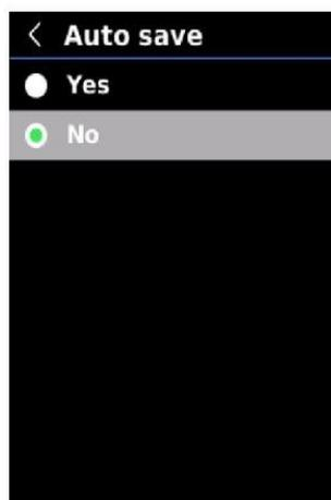
Sur l'interface de Réglage, appuyez sur le bouton Haut/Bas pour sélectionner "Enregistrement automatique", puis appuyez sur le bouton SET pour accéder au sous-menu. Appuyez sur le bouton Haut/Bas pour sélectionner Oui/Non, puis appuyez sur le bouton SET pour confirmer la sélection. Appuyez sur le bouton de Retour pour revenir à l'interface précédente.
