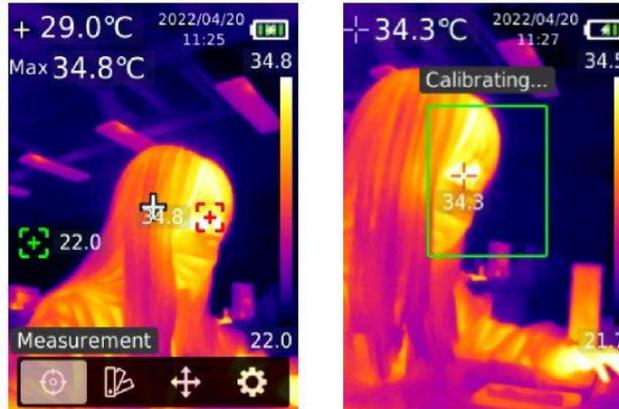
Sur l'interface principale, appuyez sur le bouton SET pour accéder au menu principal. Appuyez sur le bouton Gauche/Droite pour sélectionner "Mesures", et appuyez sur le bouton SET pour accéder au sous-menu. Appuyez sur le bouton Haut/Bas pour sélectionner le Point central/Point Max/Point Mini/Région d'intérêt. Appuyez sur le bouton de Retour pour revenir à l'interface précédente.
