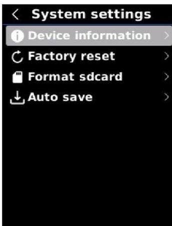
Sur l'interface de Réglage, appuyez sur le bouton Haut/Bas pour sélectionner "Réglages du système", puis appuyez sur le bouton SET pour accéder à l'interface de réglage. Appuyez sur le bouton Haut/Bas
