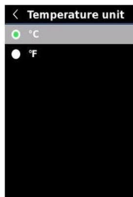
Sur l'interface de Réglage, Appuyez sur le bouton Haut/Bas pour sélectionner "Unité de température", et appuyez sur le bouton SET pour accéder à l'interface de réglage de l'unité. Appuyez sur le bouton
