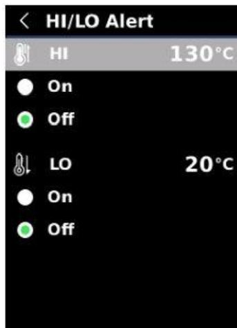
Sur l'interface de Réglage, Appuyez sur le bouton Haut/Bas pour sélectionner "Alarme Haut/Bas", et appuyez sur le bouton SET pour accéder à l'interface de réglage de l'alerte. Appuyez sur le bouton Haut/Bas pour sélectionner Marche/Arrêt. Appuyez sur le bouton SET pour régler la valeur d'alarme. Appuyez sur le bouton Haut/Bas pour ajouter/soustraire. Appuyez sur le bouton de Retour pour revenir à l'interface précédente.
