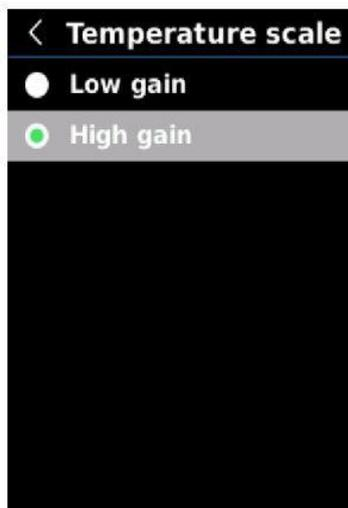
Sur l'interface de Réglage, appuyez sur le bouton Haut/Bas pour sélectionner "Échelle de température", et appuyez sur le bouton SET pour accéder à l'interface de Réglage de l'échelle. Appuyez sur le bouton Haut/Bas pour sélectionner Gain Bas/Haut, puis appuyez sur le bouton SET pour confirmer la sélection. Appuyez sur le bouton de Retour pour revenir à l'interface précédente.
