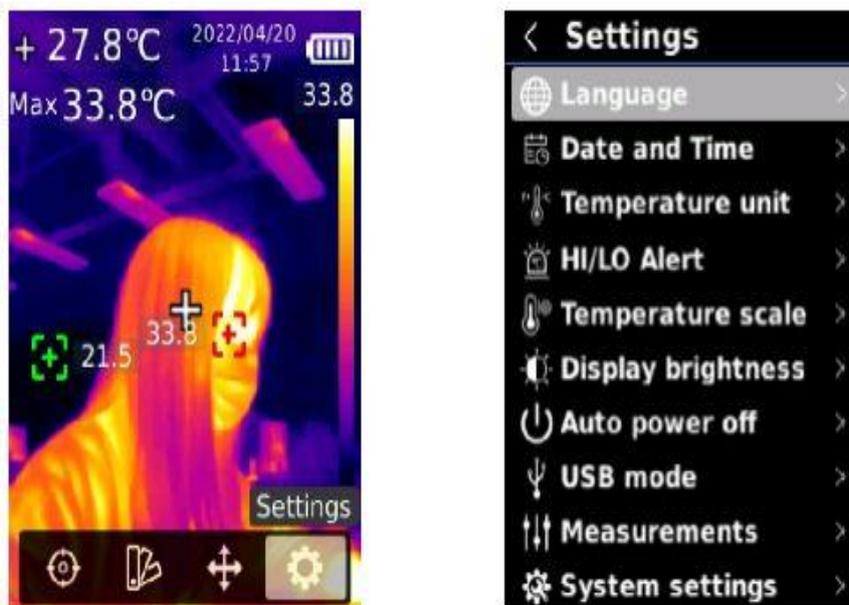
Sur l'interface principale, appuyez sur le bouton SET pour accéder au menu principal. Appuyez sur le bouton Gauche/Droite pour sélectionner "Paramètres", et appuyez sur le bouton SET pour accéder au sous-menu. Appuyez sur le bouton Haut/Bas pour sélectionner une option dans le sous-menu et appuyez sur le bouton SET pour accéder à l'interface de Réglage. Appuyez sur le bouton de Retour pour revenir à l'interface précédente.
