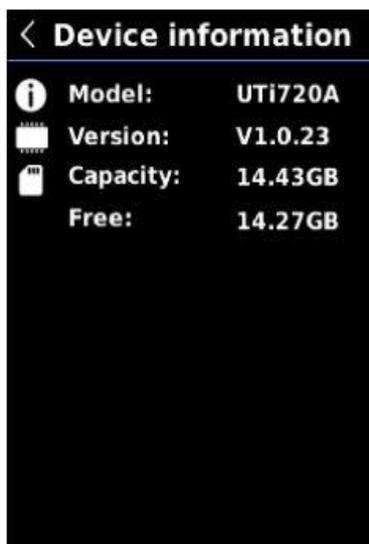
Sur l'interface de Réglage, appuyez sur le bouton Haut/Bas pour sélectionner "Informations sur l'appareil", puis appuyez sur le bouton SET pour accéder au sous-menu. La version du modèle/Capacité/Libre peut être visualisée. Appuyez sur le bouton de Retour pour revenir à l'interface précédente.
