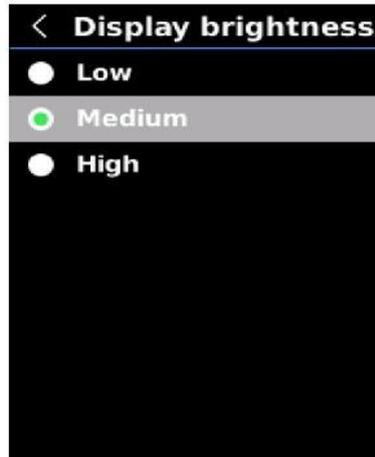
Sur l'interface de Réglage, appuyez sur le bouton Haut/Bas pour sélectionner "Luminosité de l'affichage", et appuyez sur le bouton SET pour accéder à l'interface de réglage de la luminosité. Appuyez sur le bouton Haut/Bas pour sélectionner Faible/Moyen/Élevé, puis appuyez sur le bouton SET pour confirmer la sélection. Appuyez sur le bouton de Retour pour revenir à l'interface précédente.
