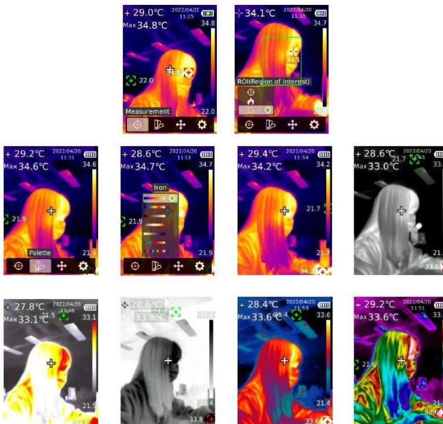
Sur l'interface principale, appuyez sur le bouton SET pour accéder au menu principal. Appuyez sur le bouton Gauche/Droite pour sélectionner "Palette", et appuyez sur le bouton SET pour accéder au sous-menu. Appuyez sur le bouton Haut/Bas pour sélectionner une palette. Appuyez sur le bouton SET pour effectuer la palette sélectionnée. Appuyez sur le bouton de Retour pour revenir à l'interface précédente.
