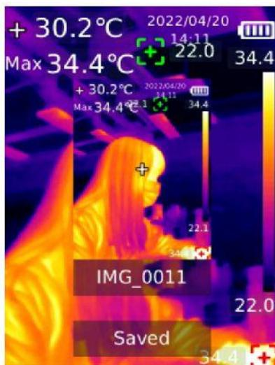
Appuyez sur le déclencheur pour capturer une image. Appuyez sur le bouton Gauche/Droite pour enregistrer ou annuler une image, et appuyez sur le bouton SET pour confirmer la sélection ou sur le bouton de Retour pour annuler la sélection. Les images seront automatiquement enregistrées sur la carte SD en mode de l'enregistrement automatique.
