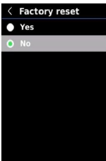
Sur l'interface de Réglage, appuyez sur le bouton Haut/Bas pour sélectionner "Réinitialisation aux valeurs d'usine", et appuyez sur le bouton SET pour accéder au sous-menu. Appuyez sur le bouton Haut/Bas pour sélectionner Oui/Non, puis appuyez sur le bouton SET pour confirmer la sélection. Appuyez sur le bouton de Retour pour revenir à l'interface précédente.
