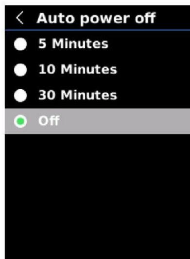
Sur l'interface de Réglage, appuyez sur le bouton Haut/Bas pour sélectionner "Arrêt automatique", puis appuyez sur le bouton SET pour accéder à l'interface de réglage. Appuyez sur le bouton Haut/Bas pour sélectionner 5 minutes/10 minutes/30 minutes/Arrêt, puis appuyez sur le bouton SET pour confirmer la sélection. Appuyez sur le bouton de Retour pour revenir à l'interface précédente.
