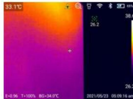
1. Barra di Stato Superiore: visualizza laser, zoom digitale, torcia, WiFi, Bluetooth, carica della batteria e stato di carica;
