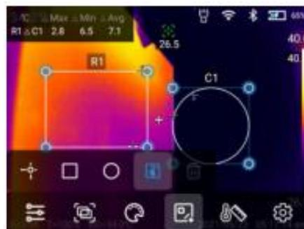
5. Isoterma: la linea dell'isoterma verso l'alto, la linea dell'isoterma verso il basso, l'isoterma al di fuori dell'intervallo e l'isoterma all'interno dell'intervallo possono essere impostate per la regolazione automatica, mentre la regolazione manuale può essere impostata manualmente.
