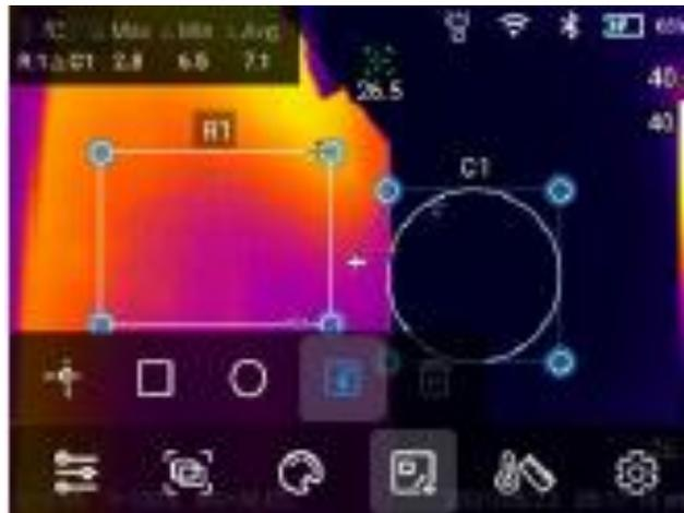
5. Isotherme: Im Modus für automatische Abblendung können die Aufwärtsisotherme, die Abwärtsisotherme, die Isotherme außerhalb des Intervalls und die Isotherme innerhalb des Intervalls eingestellt werden, und im Modus für manuelle Abblendung können sie manuell eingestellt werden.
